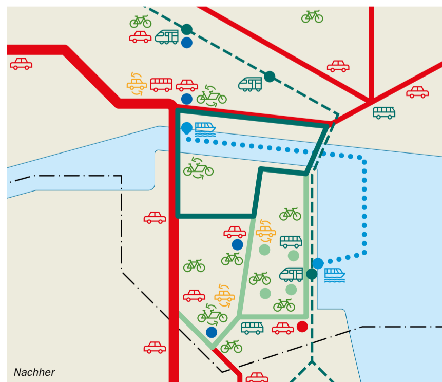
Verkehrssystem autofreie Innenstadt: Die Bedingungen für den Fuß- und Radverkehr werden verbessert und der öffentliche Verkehr ausgebaut. An Mobilitätspunkten werden die Verkehrsarten verknüpft und Mietsysteme angeboten. Eine kostenlose Bus-Ringlinie (—) und der Wasserbus (•••••) bringen Besucher vom zentralen P+R Brückenquartier in die Innenstadt.
