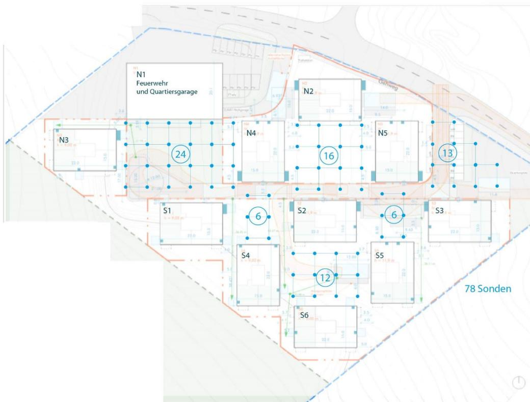
Abbildung 4-5: Maximale Anzahl der Erdwärmesonden im Quartier bei Sondenabstand 8 m.
