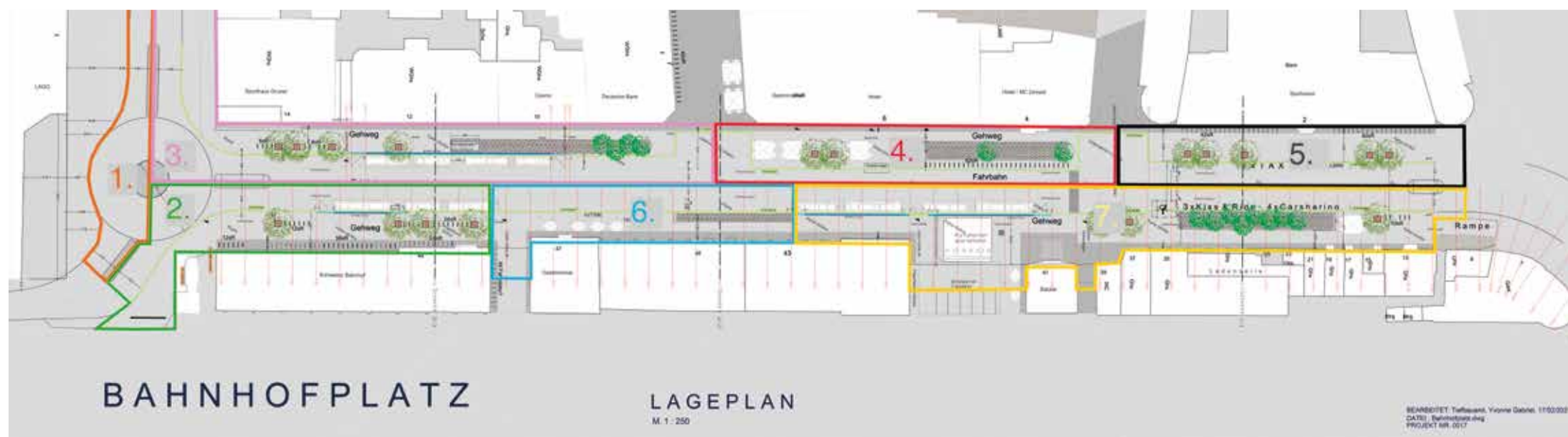
In sieben Bauabschnitten wird der Konstanzer Bahnhofplatz in den kommenden Monaten saniert, beginnend mit dem Kreisverkehr vor dem Lago-Center, auf dem Plan links zu sehen.
