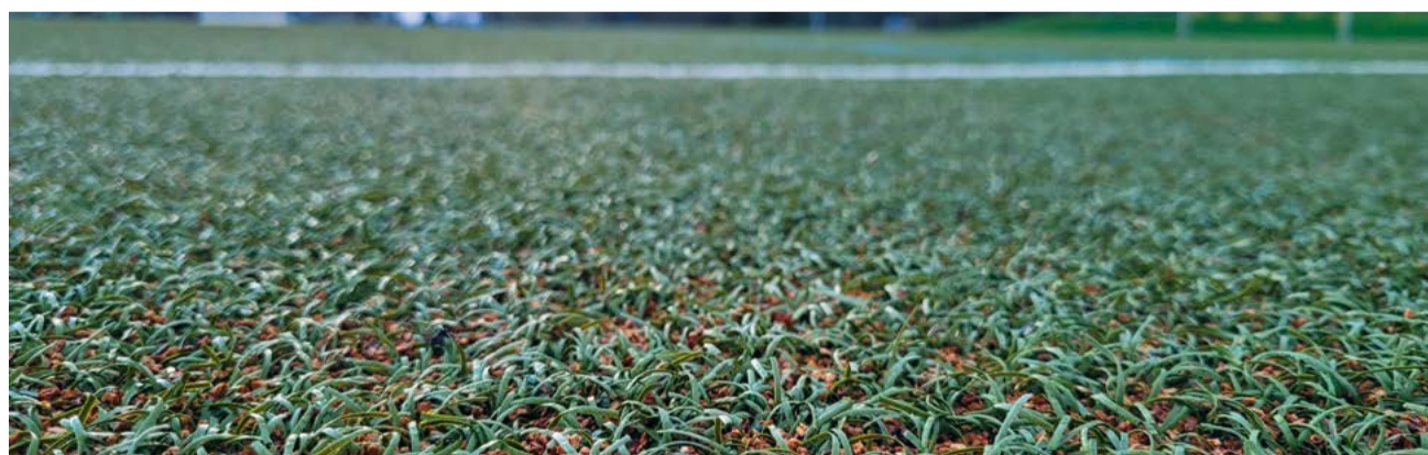
Der Litzelstetter Kunstrasenplatz war der erste Konstanzer Sportplatz, der nachhaltig mit Kork verfüllt wurde. Inzwischen folgten weitere.
