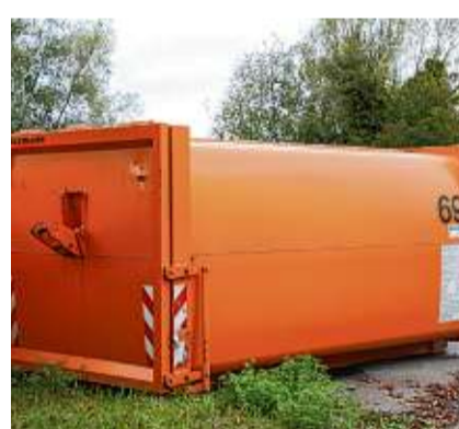
Eine Presse drückt den Restmüll in diese Behälter. Sie werden per Lastwagen und Zug nach Weinfelden transportiert.
