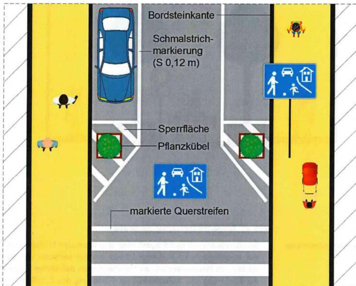
Abb. 42: Gestaltung eines Verkehrsberuhigten Bereichs mittels Markierungslösungen
