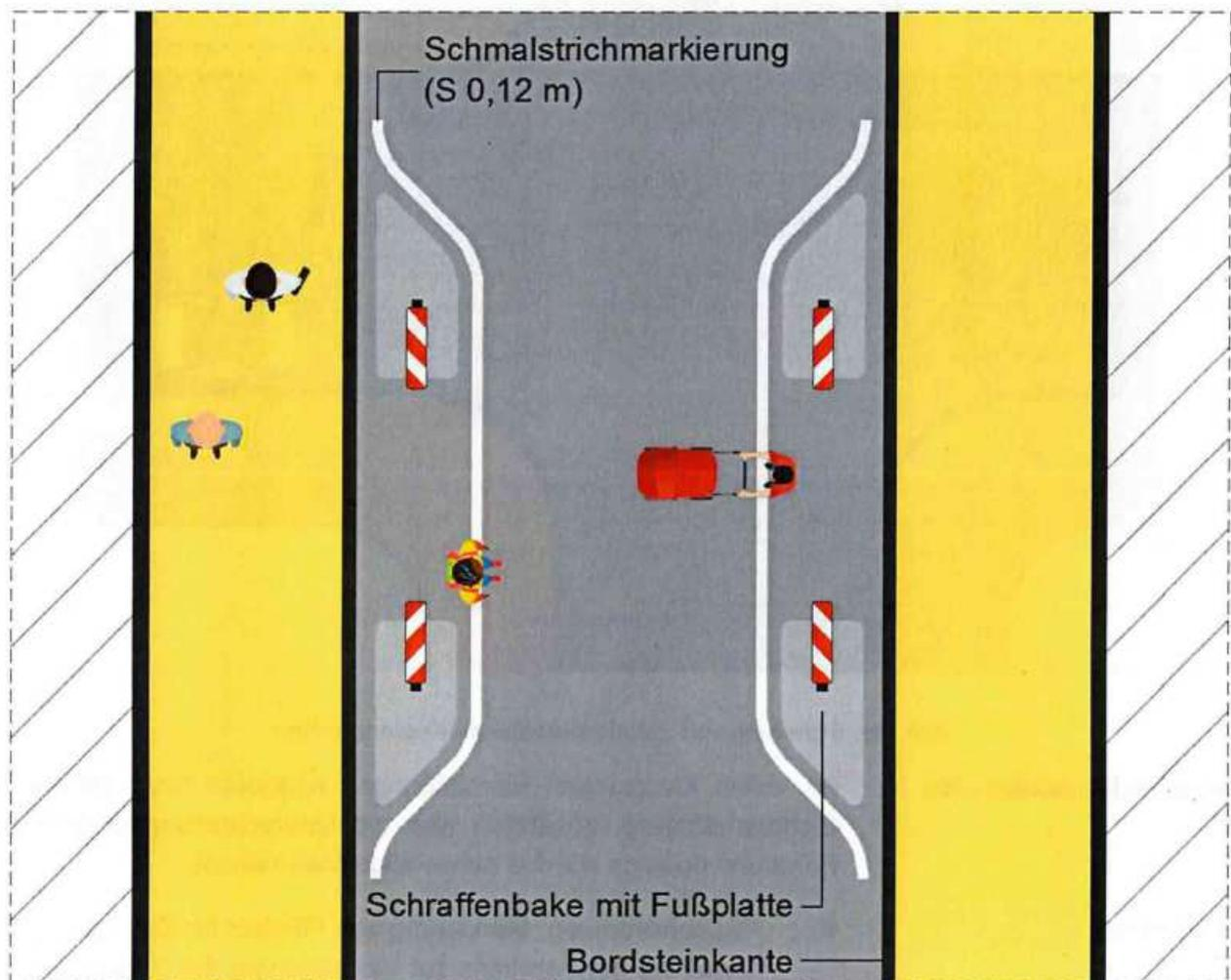
Abb. 39: Sofortmaßnahme: Querungshilfe auf der Strecke mittels Engstelle
