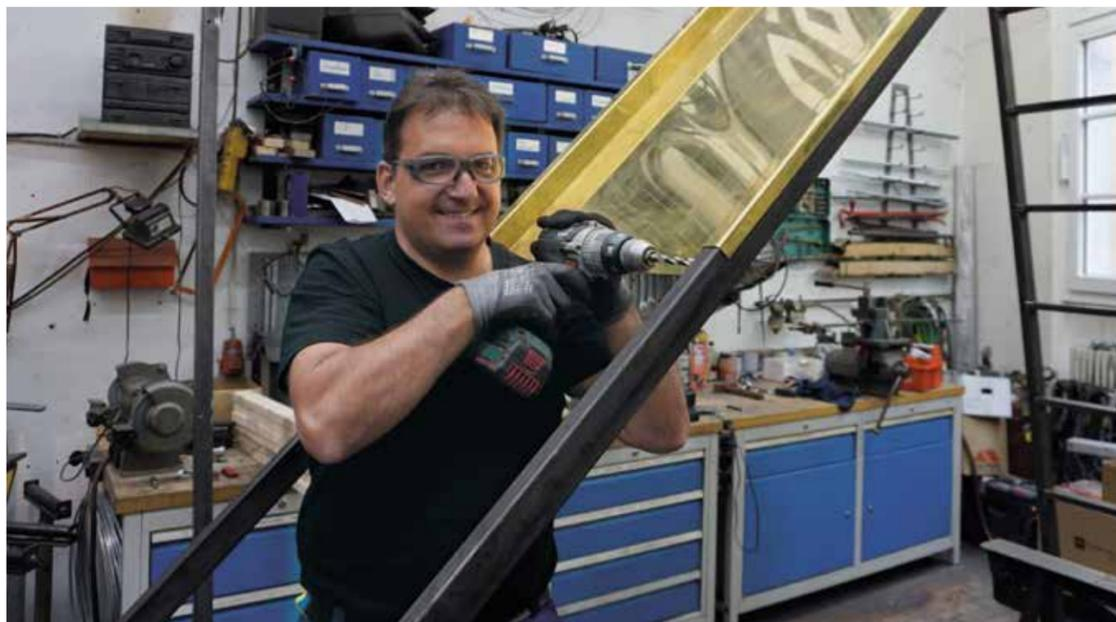
Jürgen Kelm beim Bohren an der Schwimmbadrutsche für das Stück „Die Vögel“. Das Grundgerüst ist aus Stahl, die Rutsche aus Messingblech, um ihr den gewünschten goldenen Glanz zu geben.
