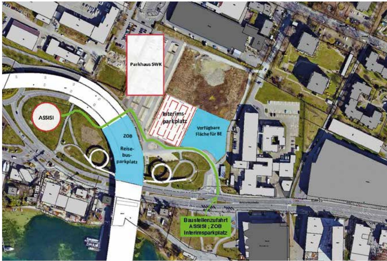
Mit dem Brückenquartier entsteht auch ein neuer Mobilpunkt, zu dem ein neues Parkhaus gehören wird. Damit dieses gebaut werden kann, wird in direkter Nähe ein Interimparkplatz ausgewiesen. Angrenzend wird eine Fläche für die Baustelleneinrichtung (BE) zur Verfügung gestellt.
